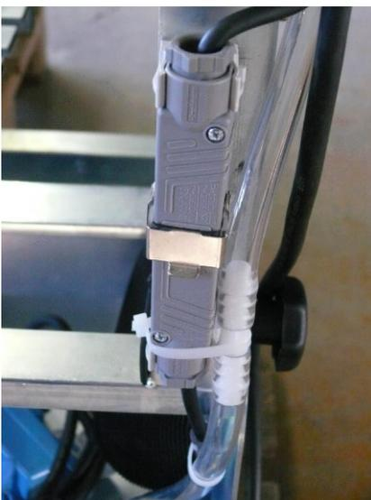
Steckbare Wasserpumpe für ein rasches und sicheres Auswechseln der Wasserpumpe.
