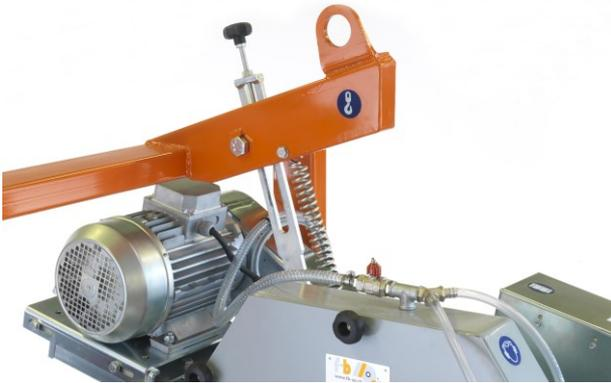
Ein zentraler Kranhaken. Motor mit elektrischer Bremse sichert das rasche Anhalten der Diamanttrennscheibe.
