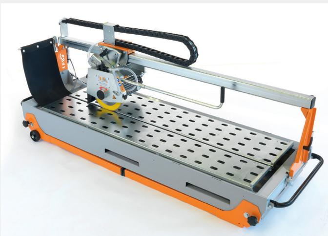
Klappbare Standfüsse ermöglichen den einfachen Transport.
