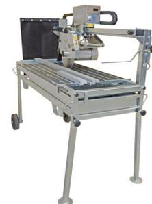
**Diamatic A-115** – mit Drehzahlregulierung, Tisch mit gummierter Auflage, Längsanschlag, Massskala vorne und hinten, inkl. Diamant-Trennscheibe ø 350 mm, inkl. Beine mit Rädern.
