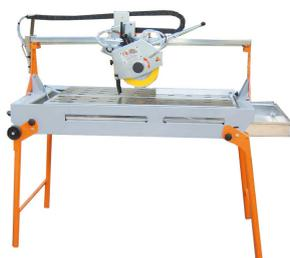
**fb 100KS mit Kabelschleppführung** – Das Leichtgewicht mit 1000 mm Schnittlänge, inkl. Dia-Scheibe ø 230 mm zum Schneiden von Keramik und Feinsteinzeug und Längsanschlag aus Aluminium. Seitentisch optional zusätzlich erhältlich.
