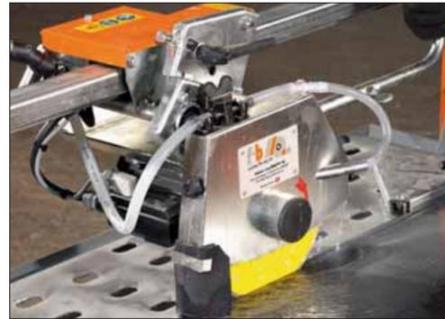
Mobiler mehrfachgelagerter Schneidekopf mit Wippe und integriertem Gasdruckdämpfer, sichert einen präzisen Schnitt.
