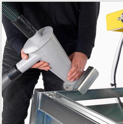
Einfacher und 100% werkzeugloser Umbau von der Trocken- zur Nassfunktion.
