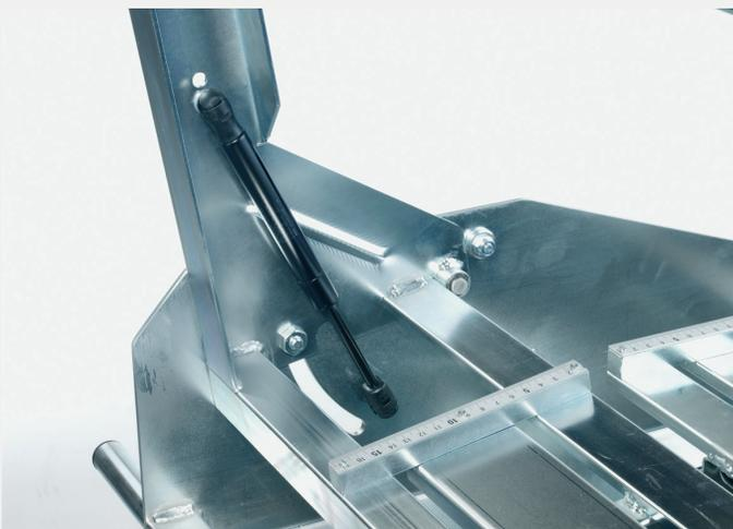
Abkippen vom Joch wird durch zwei solide Gasdruckdämpfer unterstützt.
