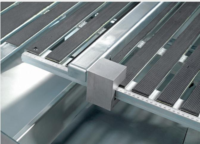
Präzise Mass-Skala auch auf der Gegenseite, damit genaue Längsschnitte realisiert werden können.
