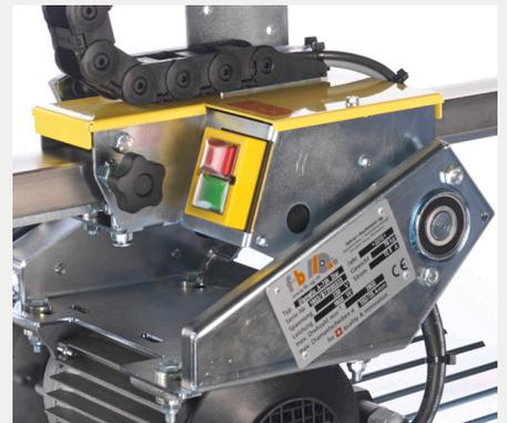
Integrierter Schalter, sowie mehrfach gelagerter Wippkopf sichern hohe Funktionalität.
