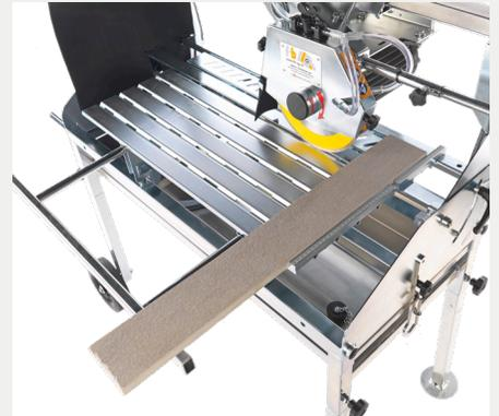
Ausziehbarer Seitentisch ermöglicht ein solides Auflegen von grossen Platten.
