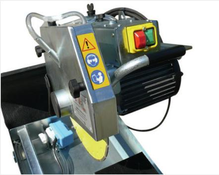
Integrierter versenkter Schalter und ein mehrfach gelagerter Wippkopf sichern Langlebigkeit und hohe Funktionalität.
