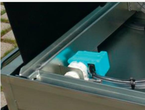
Im Rahmen integrierte, steckbare Wasserpumpe, ermöglicht ein schnelles, werkzeugloses Ersetzen der Wasserpumpe.
