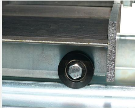
Auf Präzisions-Metallrollen/-Kugellagern geführter Schneidetisch für sicheres und präzises Arbeiten.
