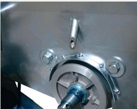
Doppelte Wasserzufuhr zur Kühlung und Schonung der Diamanttrennscheibe.
