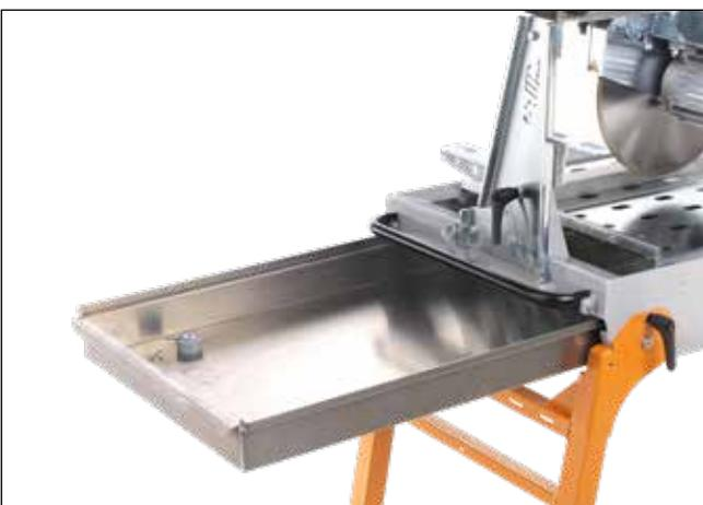
Ausziehbare, leichte Wasserwanne aus Aluminium
