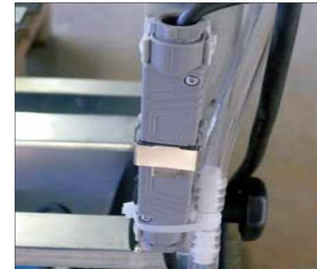
Steckbare Wasserpumpe ermöglicht ein rasches Auswechseln ohne Werkzeugeinsatz.
